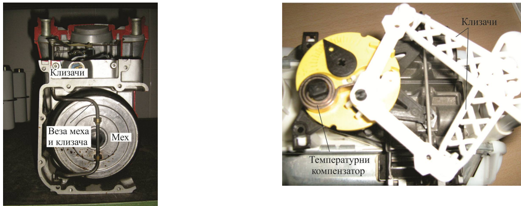
Slika 4.10 Elementi gasomera sa mehom
